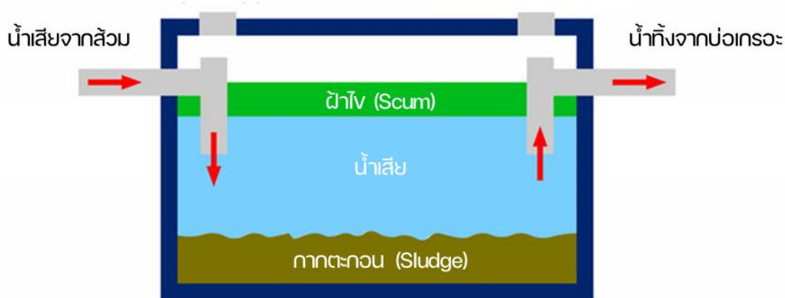
รูปที่ 10 หลักการทำงานของบ่อเกรอะ
